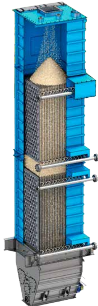
Acondicionador vertical de placas
