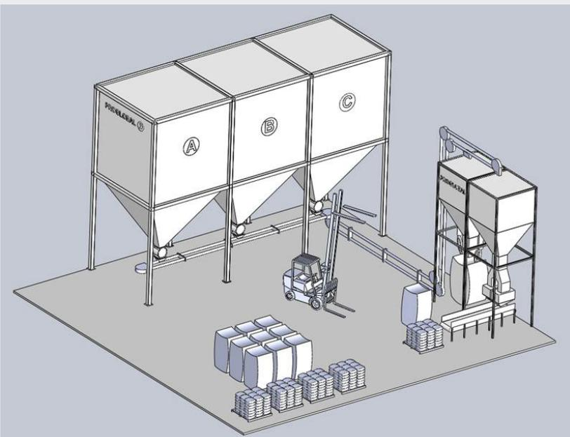
Ingeniería básica indicativa y preliminar de molino y packaging. Tenemos diversos modelos de arreglos a medida de los usuarios para que después se pueda avanzar directamente a la ingeniería de detalle con transportes, conexiones, tolvas y control con la correspondiente red eléctrica. Molinos completos, ampliaciones y mejoras están al alcance de los clientes de manera muy simple.
